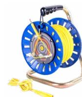
**Cavo 75 / 100 / 200 m sulla bobina per misura di terra giallo**
